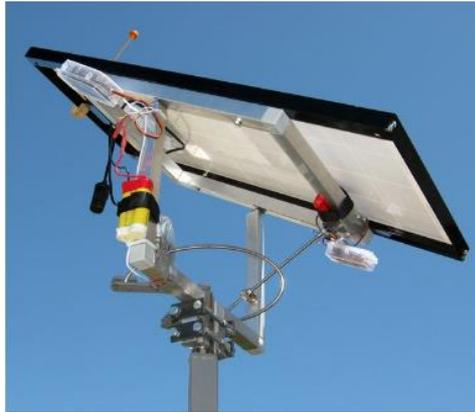
Figura 2-1 Sistema de seguimiento solar de 2 ejes [1]
