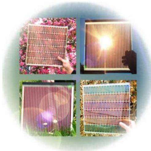
Figura 2-6 Células de pigmento fotosensible o células Grätzel. [14]
