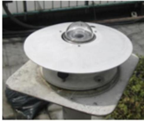
**Figura 2-4** Piranómetro destapado (mide radiación global) [9]
