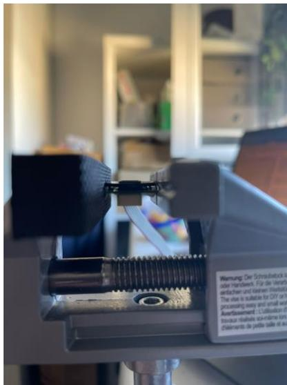
Figura 7-3 Sensor posicionado en la morsa 2.
