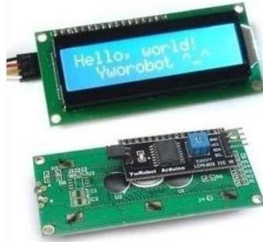
Figura 4-6 Pantalla LCD 16x2 con I2C [39]
