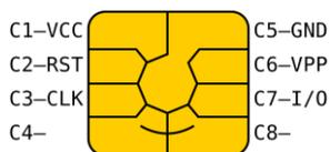
Ilustración 18: Ubicación y contactos de una tarjeta de circuito integrado
