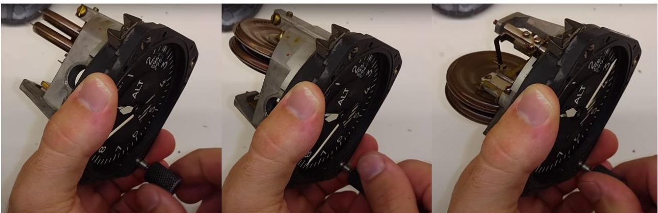
Figura 18 – Secuencia de fotogramas obtenidos a partir de la Referencia [44] en la que se muestra el funcionamiento del ajuste de Kollsman en un altímetro barométrico real
