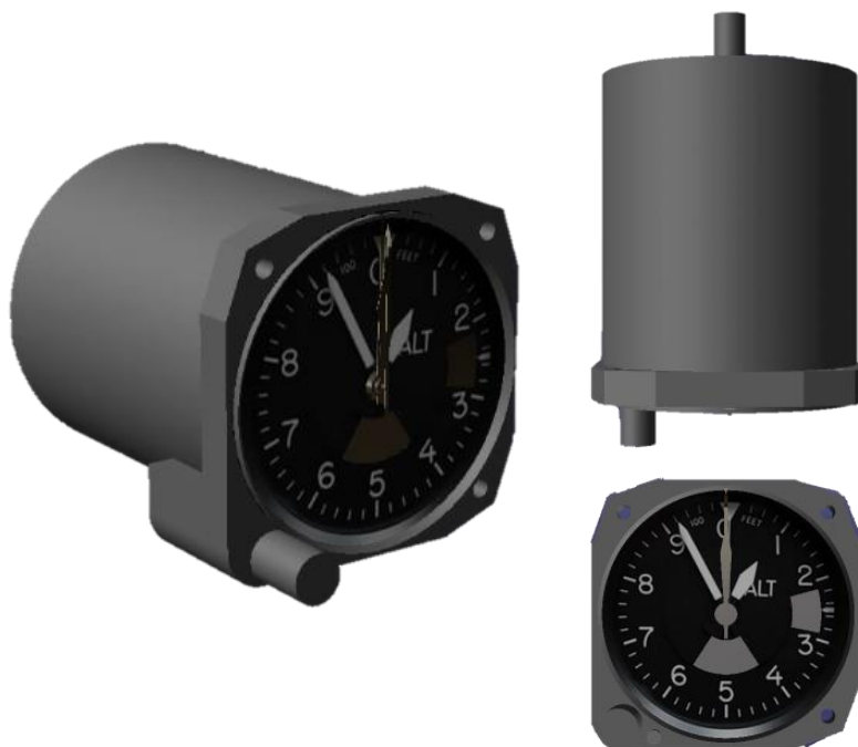
Figura 14 – Modelo tridimensional de la geometría y tamaño del altímetro objetivo realizado mediante el software de modelado 3D “CATIAV5”
