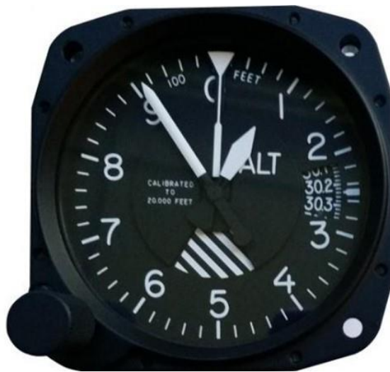
Figura 15 – Dial con indicador de tres agujas, una ventanilla de Kollsman y un área con franjas negras y blancas visible para altitudes inferiores a 10000 ft
