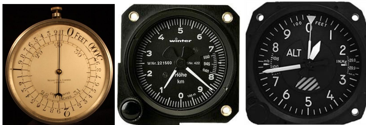
Figura 7 – Evolución de los altímetros barométricos de una aguja a tres agujas
