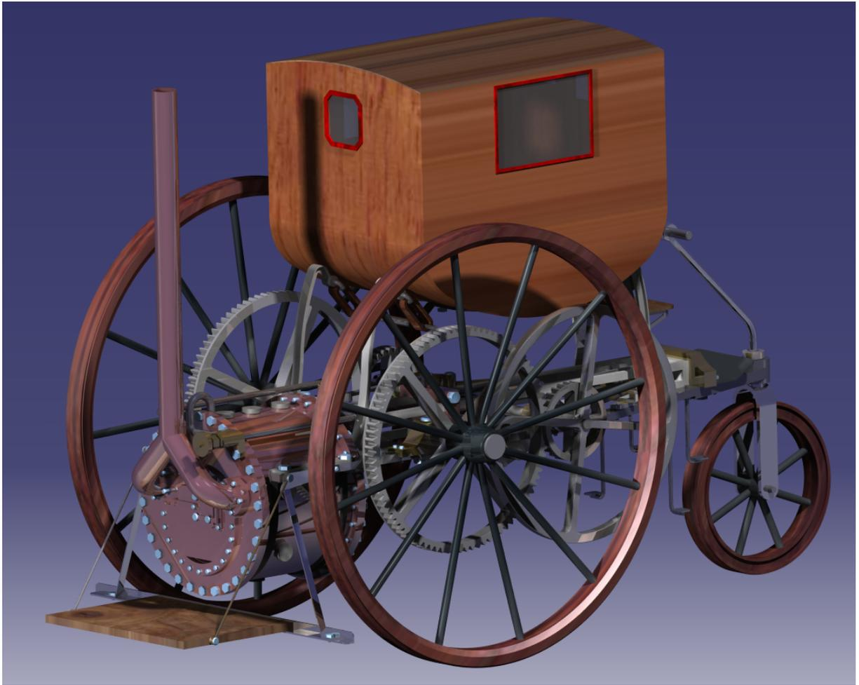
Figura 19: Parte trasera del carro de vapor de Trevithick.
