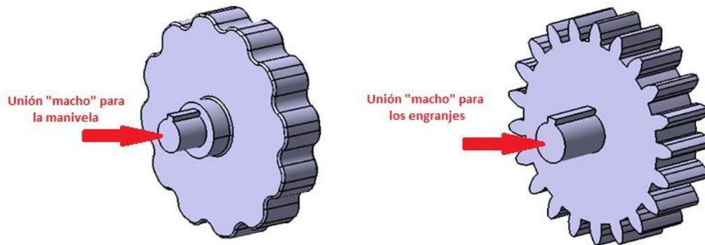
Figura 3.5. Fotografía método de unión rueda dentada y manivela.
