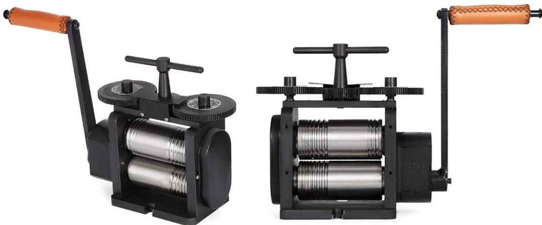
Figura 1.1. Fotografía mecanismo de laminado en joyerías [4].
