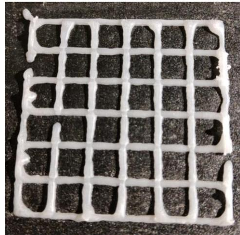
Figura 22. Mallado de dos capas sin efecto goteo
