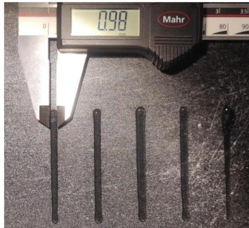
Figura 17. Prueba de anchos de líneas de gel
