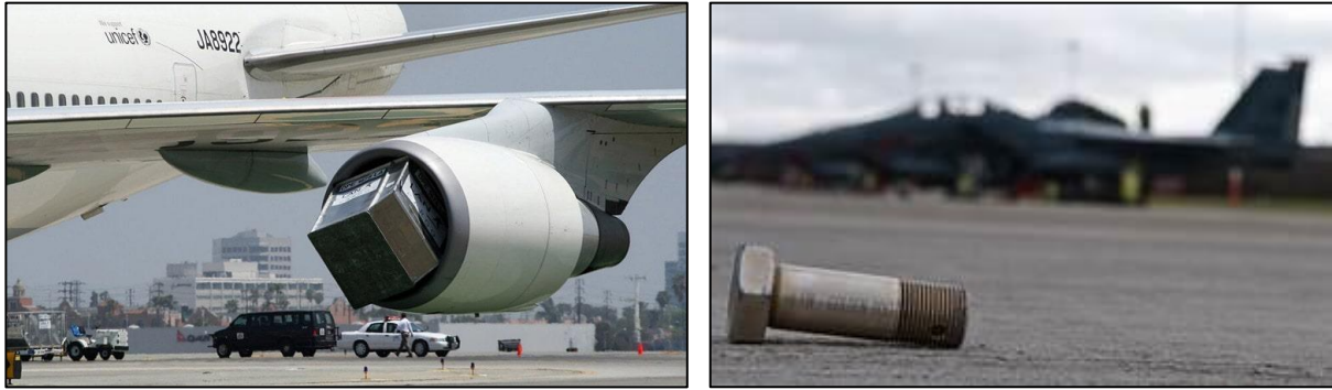
Figura 20: Contenedor absorbido por un Boeing 747. Tornillo sobre plataforma de un aeropuerto.
