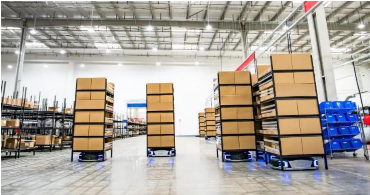
Ilustración 7. Automatización de bienes a persona del sistema GTP. (Fuente <https://www.daifuku.com>)
