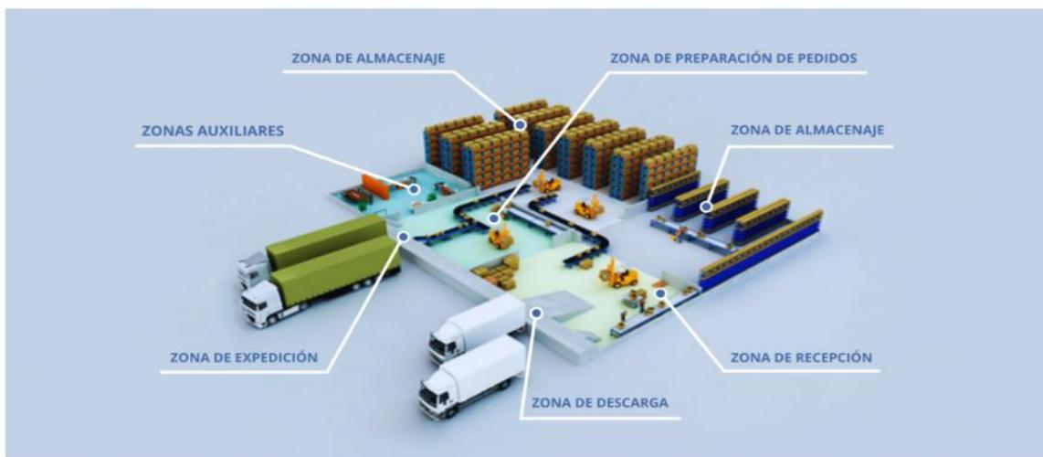
Ilustración 1. Diseño de Almacén con sus áreas más complementarias (Elaboración de <https://www.polypal.com>)
