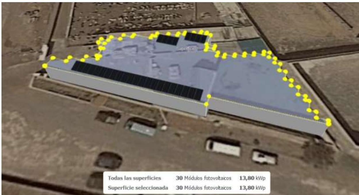
Ilustración 3: Modelado de la Instalación
