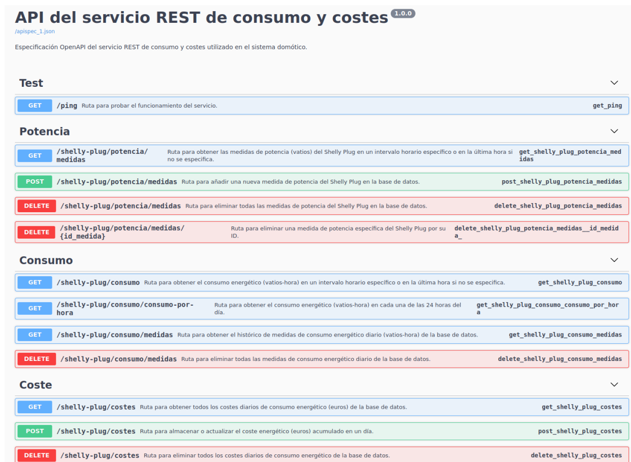
Figura 4-4. Especificación OpenAPI del servicio REST de consumo y costes
