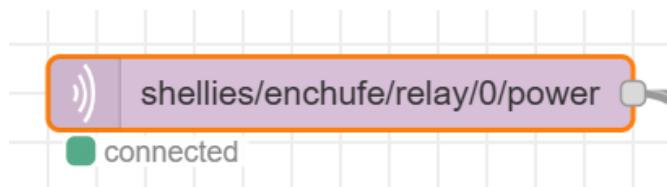
Figura 3-16. Nodo de conexión a un broker MQTT y suscripción a tópicos
