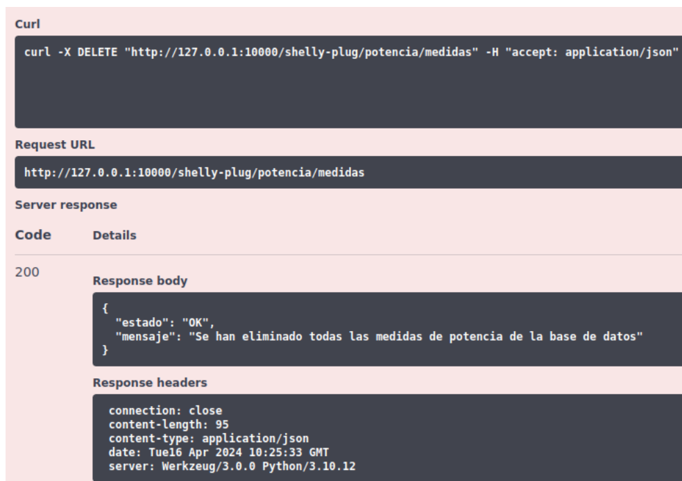
Figura 4-12. Petición DELETE a /shelly-plugin/potencia/medidas sin identificador
