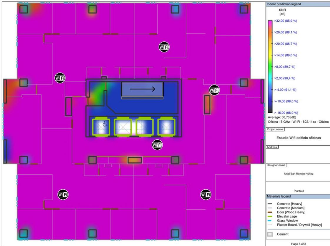
Figura 4-37. SNR 5Ghz. Planta 3.
