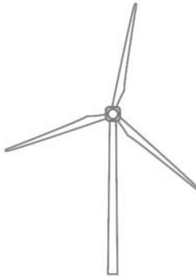
Ilustración 3-2: Aerogenerador de eje horizontal
