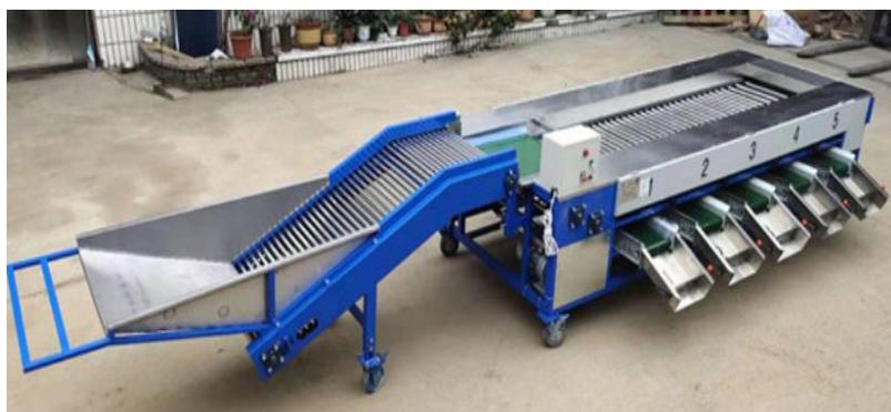
Figura 34. Mesa-cinta calibradora de tomates con rodillos.[17]
