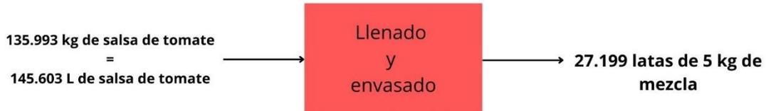
Figura 30. Balance de materia del proceso de llenado y envasado.
