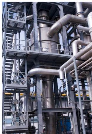
Figura 23. Cocción para concentración del tomate.
