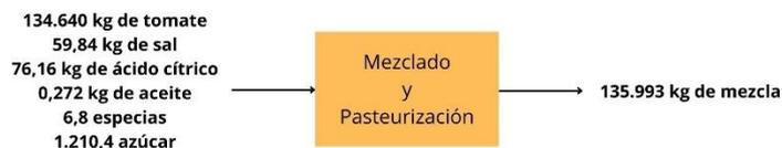
Figura 29. Balance de materia del proceso de mezclado y pasteurización.
