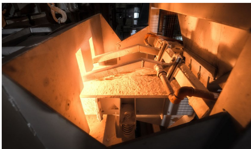
Figura 41. Entrada de la mezcla de materias primas al horno de fusión. [33]
