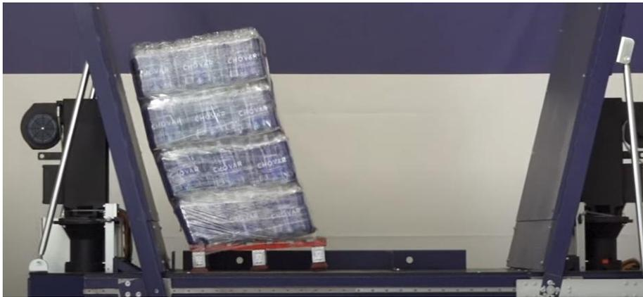
Figura 23. Lanzadera de aceleración. Fuente: (Aetna Group, s.f.)
