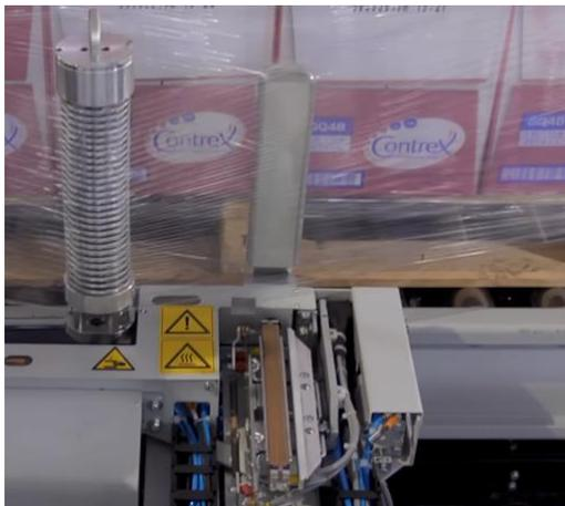
Figura 14. Sistema corte y soldadura por contraste. Fuente: (Aetna Group, s.f.)
