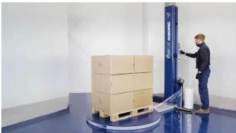
Figura 4. Máquina semi-automática. Fuente: (Controlpack, 2019)
