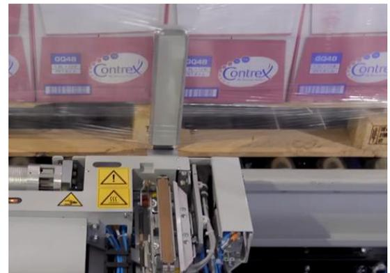
Figura 13. Sistema corte y soldadura por contraste. Fuente: (Aetna Group, s.f.)
