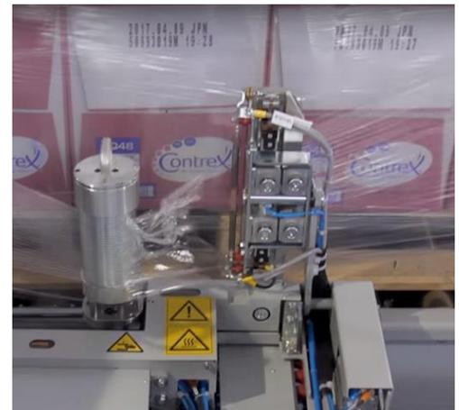
Figura 15. Sistema corte y soldadura por contraste. Fuente: (Aetna Group, s.f.)
