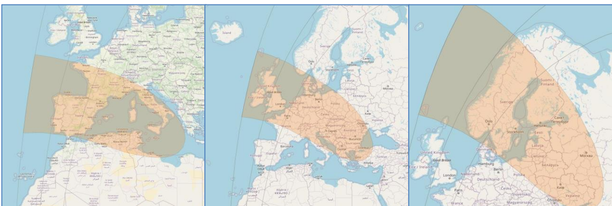
Figura 4.12. Representación de la zona de cobertura sobre la superficie de los haces S11DL, S19DL y S28DL del satélite Inmarsat-5 F1 [19].
