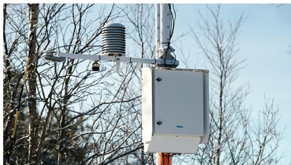
**Figura 1.1** Estación Meteorológica Automática AWS310 de la marca *Vaisala* [7].
