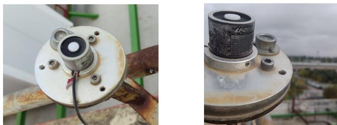
**Figura 3.6** Piranómetro *LI-COR* actualmente instalado en la estación.
