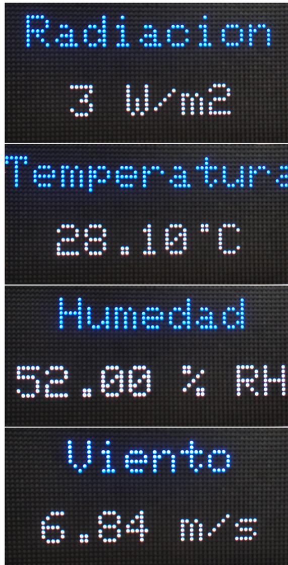
Figura 5.4 Visualización de la información meteorológica en la pantalla LED.
