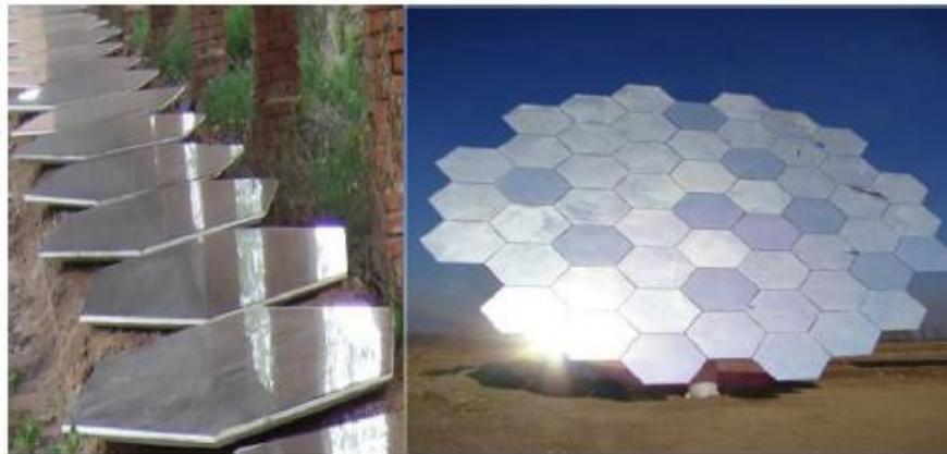
Imagen 18. Heliostatos hexagonales de 1.82 m<sup>2</sup> en Pekín [37].
