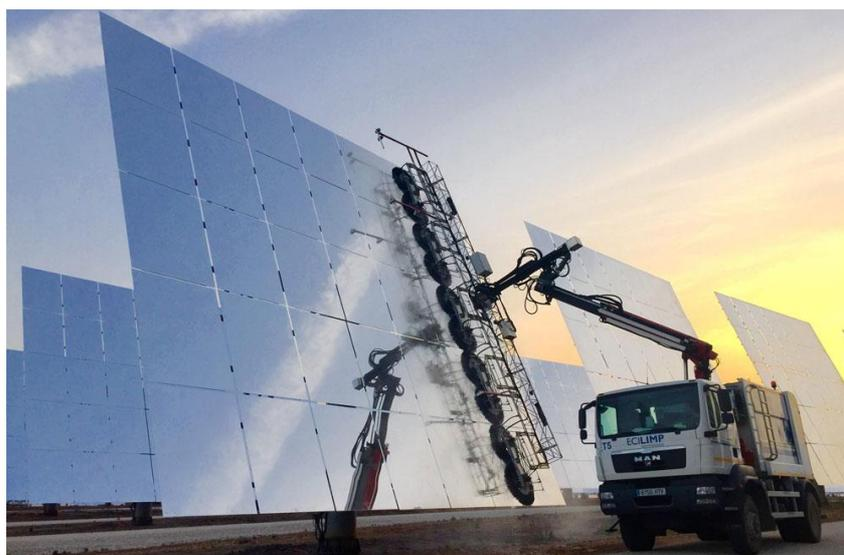
Imagen 30. Camión de limpieza de Gemasolar, propiedad de Torresol Energy © SENER, propiedad de Tecnología de Limpieza de ECILIMP [55].
