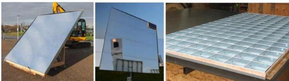
Imagen 26. Heliostato DLR sándwich de carrusel [39].
