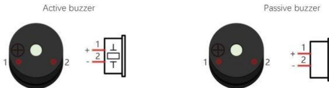
(Figura 2-8. Dibujo buzzer activo y pasivo)
