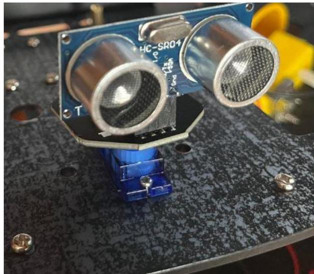
(Figura 3-12. Imagen del sensor de ultrasonido)
