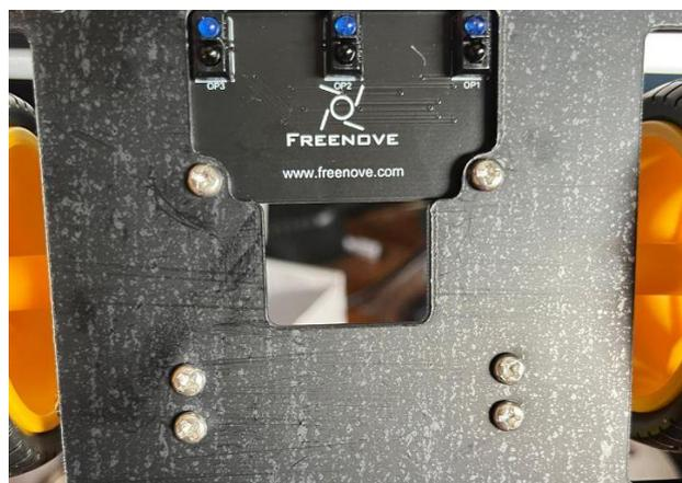
(Figura 3-10. Imagen de los sensores de tracking de línea por debajo)
