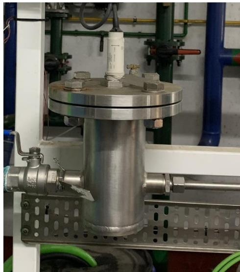
**Figura 3.10** Analizador de conductividad.
