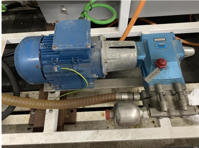
**Figura 3.5** Bomba del proceso. Bomba alternativa.
