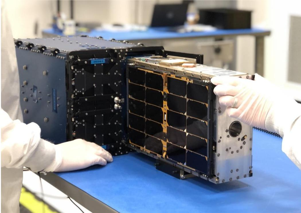
**Figura 2.** CubeSats siendo introducidos en el sistema de despliegue
