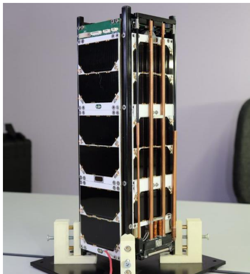
Figura 1-2. CubeSat SamSat-ION con formato 3U, desarrollado por investigadores de la universidad de Samara [7].
