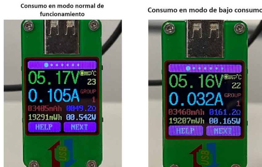
Figura 5-15. Consumos del Arduino en modo normal y en modo de bajo consumo del SAM3X8E.
