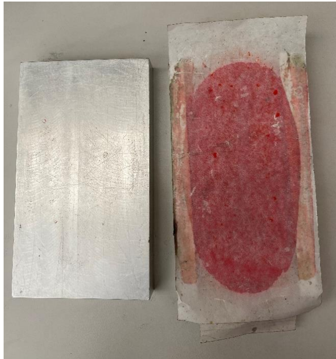
Figura 3.25 Plastilina en el molde tras el prensado
