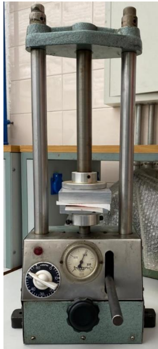
Figura 3.23 Prensa empleada en la fabricación de probetas
