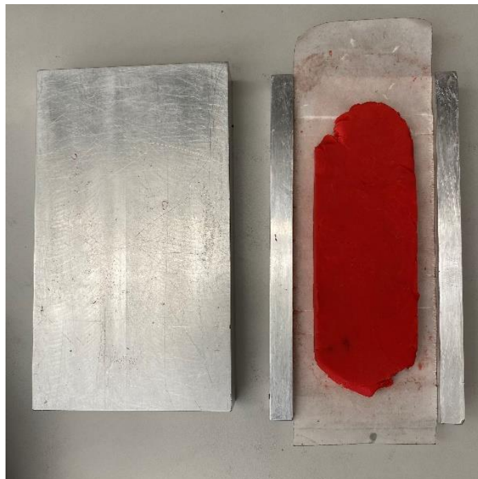
Figura 3.24 Plastilina en el molde previa al prensado
