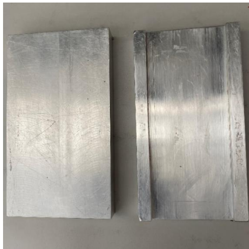
Figura 3.21 Molde para la fabricación de probetas
