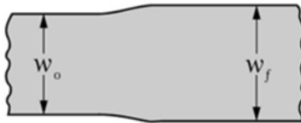
Figura 2.3 Ensanchamiento del material tras la laminación
