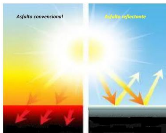
Figura 3: Pavimento reflectante. Fuente:(Cristina Ávila Freire, 2018)
