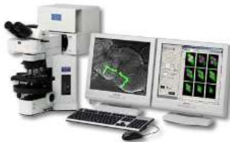
Figura 2-5. Equipo de microscopía confocal
