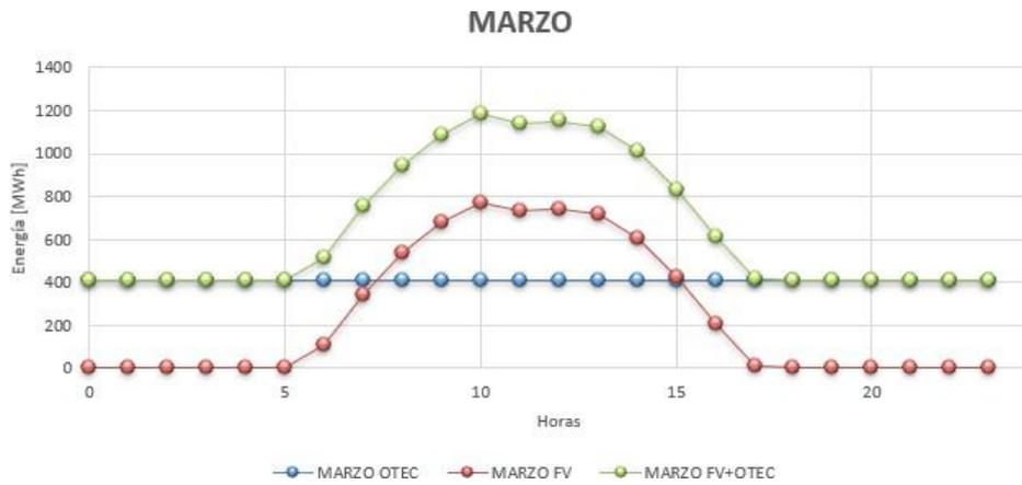
Figura 40. Comparativa de la potencia OTEC y la FV vs días modelo de marzo.
