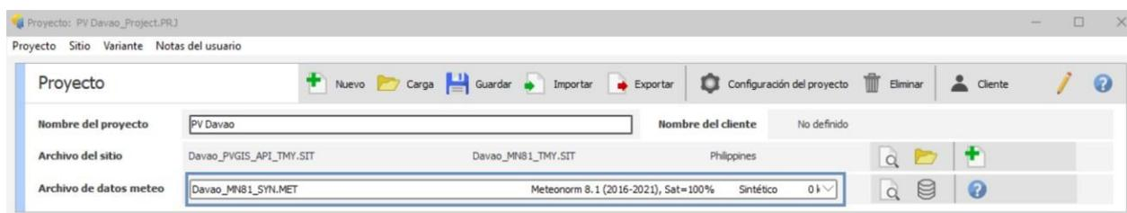
Figura 11. Introducción de los datos meteorológicos del emplazamiento. “PVsyst”.
