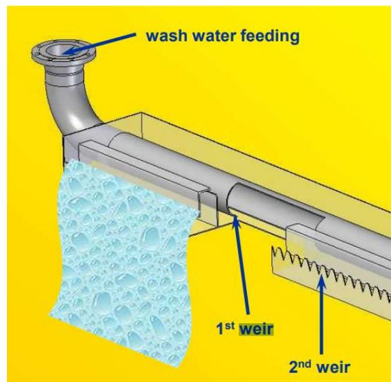
Ilustración 21. Diagrama de sistema de distribución de agua de lavado de un filtro pan
