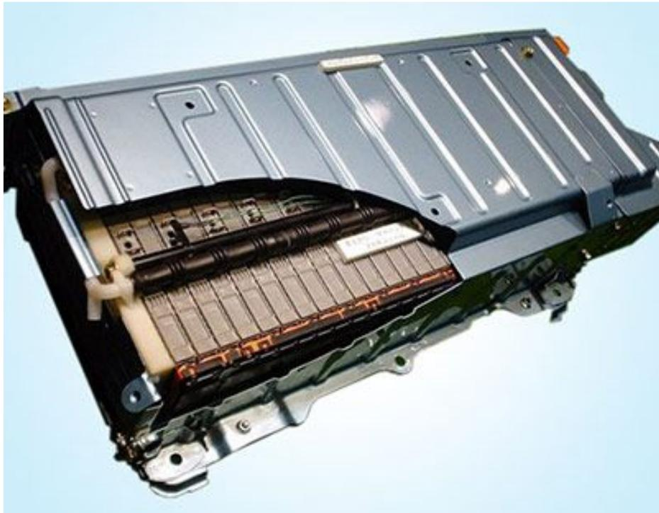
**Figura 1.2** Batería de Níquel-metal hidruro. Fuente: [www.electriccarsguide.com.au](http://www.electriccarsguide.com.au).
