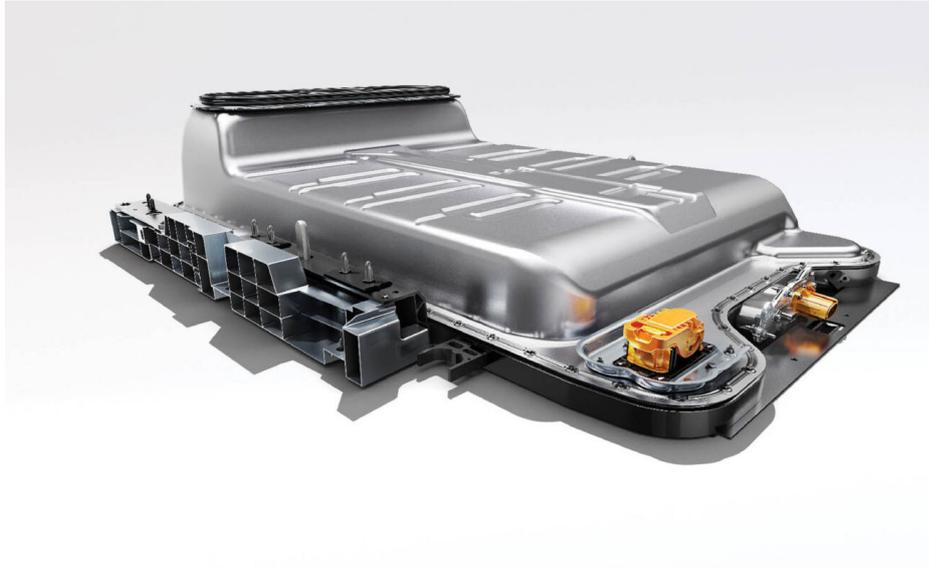
**Figura 1.1** Batería de iones de litio. Fuente: [www.renaultgroup](http://www.renaultgroup).
