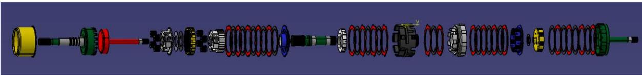
Figura 6-7. Elementos de la caja de cambios ordenados
