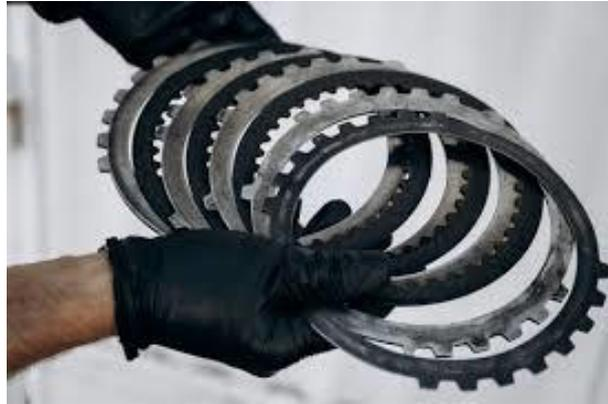
Figura 2-14. Embrague de una caja de cambios automática
