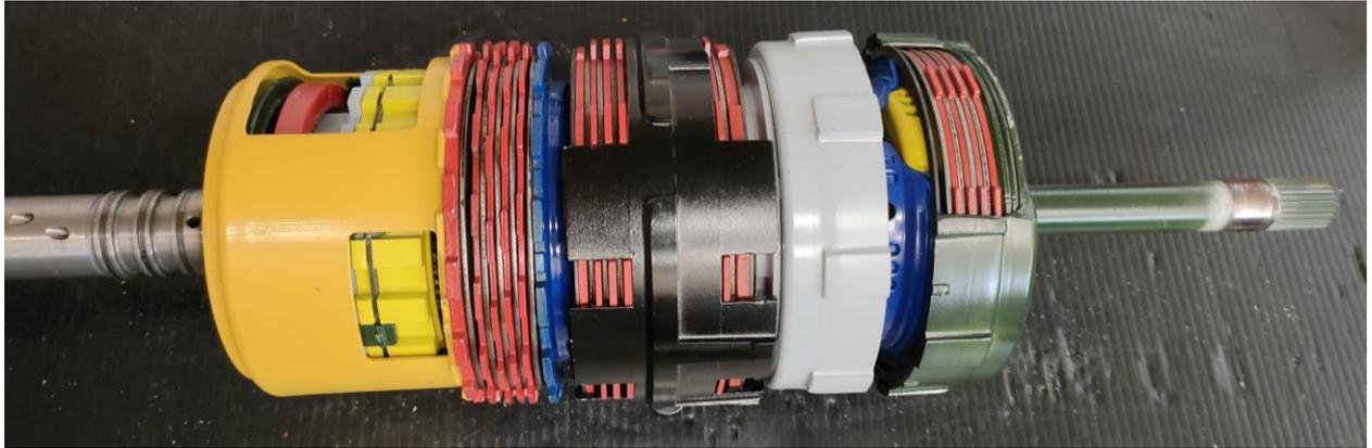
*Figura 6-9. Fotografía real de la caja de cambios completa*
