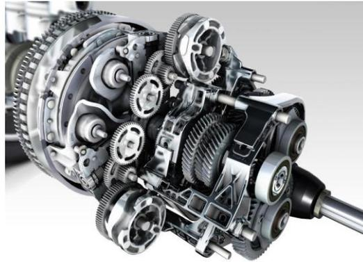
*Figura 2-17. Caja de cambios de transmisión de doble embrague*
