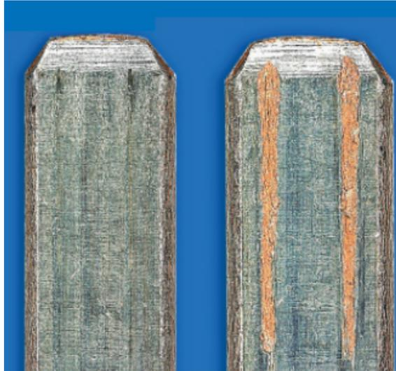
Figura 1.3 Diferencias de daño entre el uso y no uso de lubricantes.
