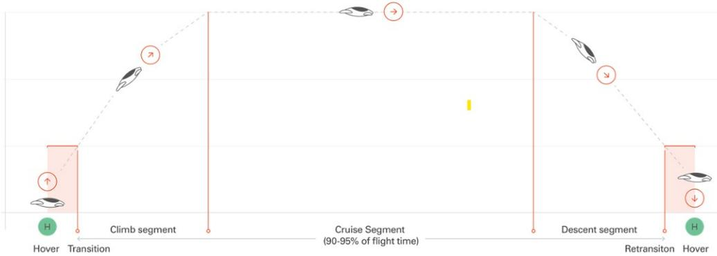
**Figura 1.4** Perfil típico de una misión de un VTOL [11].
