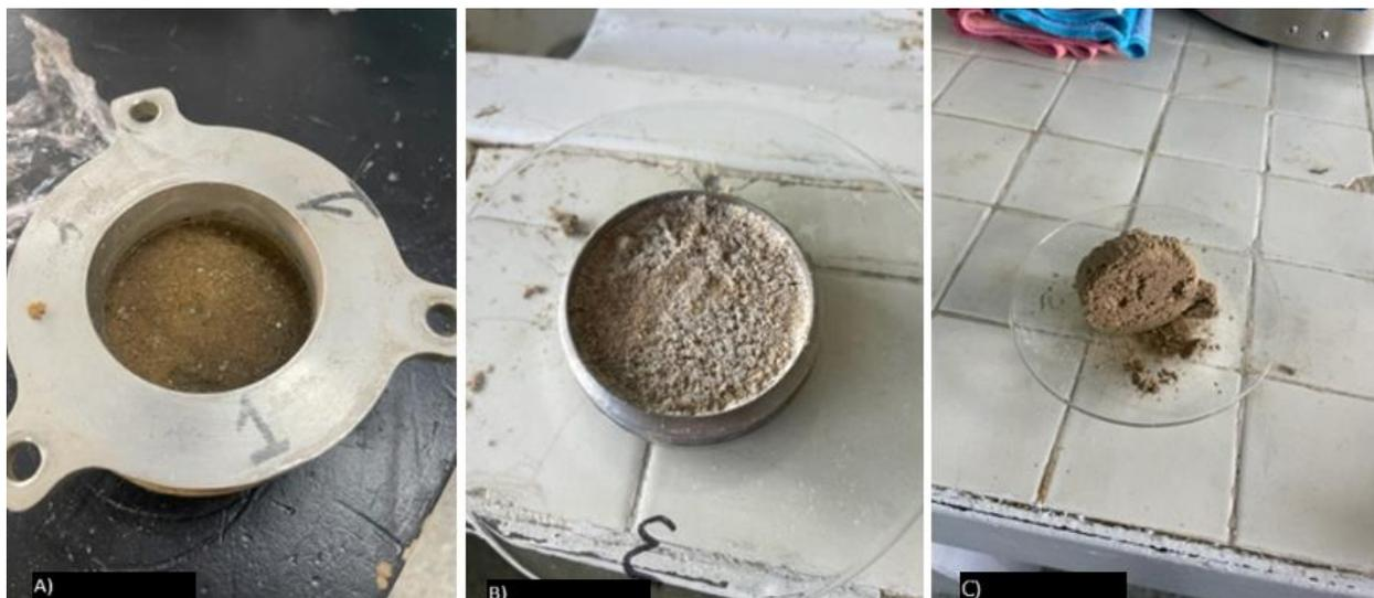
**Fig. 6.** Muestras ensayadas, donde en A) se observa la muestra a ensayar tras aplicarle la mezcla de Ludox y NaCl, en B) se observa la muestra tras el proceso de secado en el horno y en C) se observa la muestra tras retirarle el anillo, donde se aprecia que el resultante es homogéneo.
