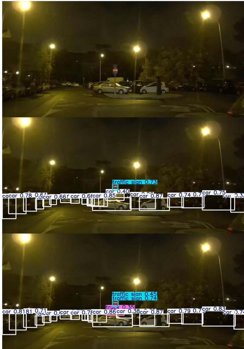
**Figura 4.7** Predicción de los modelos de detección de YOLOv8 ante una situación de tráfico común nocturna.
