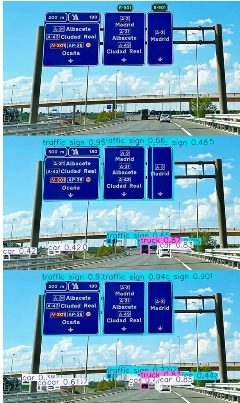
**Figura 4.5** Predicción de los modelos de detección de YOLOv8 ante una situación de tráfico común.
