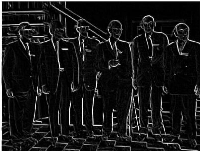
Como se puede apreciar tanto con el filtro de Sobel como con el de Prewitt se obtiene un resultado donde se resaltan los contornos mejor que con el filtro de Roberts y con el filtro del gradiente.
