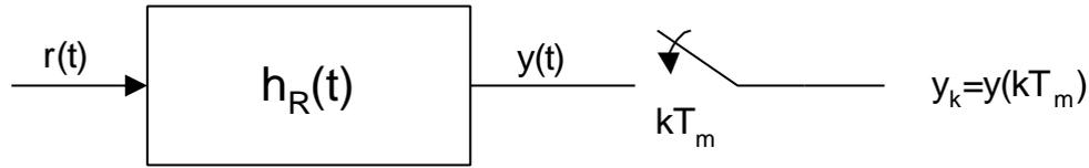
Figura 2.11.- Proceso a la entrada de un receptor en banda base.
