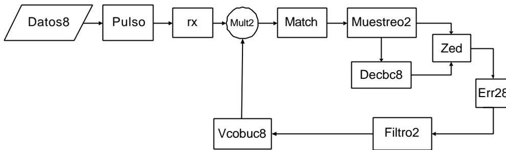
Figura 5,63.- Diagrama de los bloques empleados para el caso 8-PSK en bucle cerrado.
