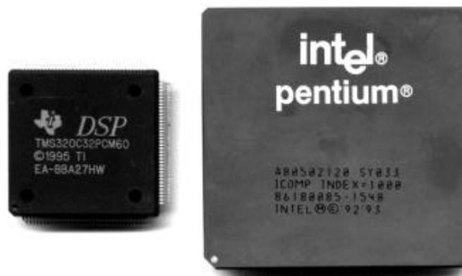
Figura 1.3. Fotografía de un DSP, TMS230C32, de Texas Instruments y de un microprocesador pentium de Intel.
