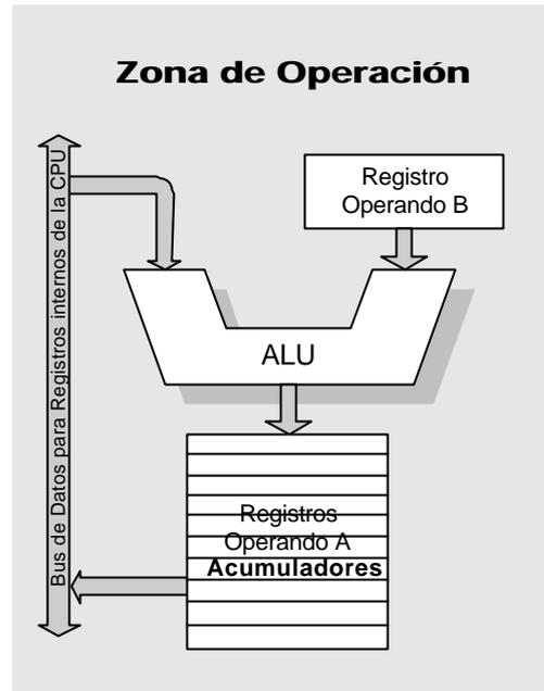
Figura 1.7. Estructura interna orientada a registro.
