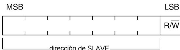
**Figura 70.** Direccionamiento de un SLAVE.
