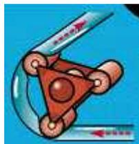
Fig.29 Principio de funcionamiento de una bomba peristáltica.
