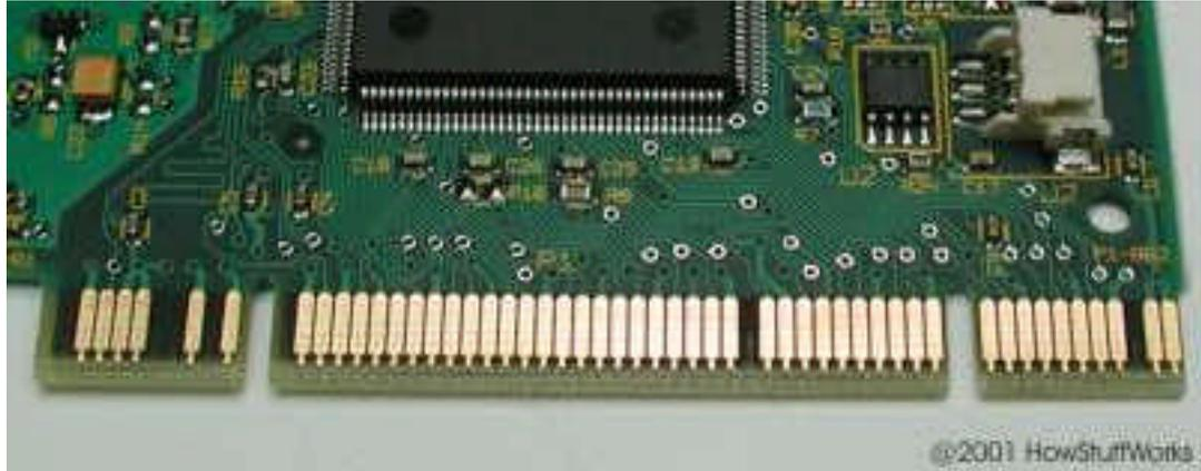
Fig.39 Los 47 pines de la tarjeta se conectan dentro del slot libre del PC.
