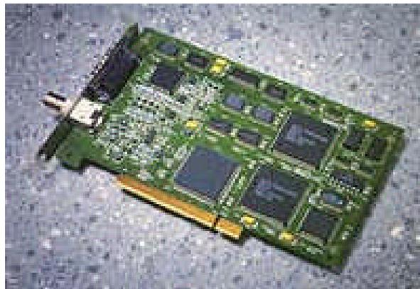
Fig. 16 Modelo DT3155 del fabricante Data Translation. Otro ejemplo de tarjeta de adquisición de datos con bus PCI integrado
