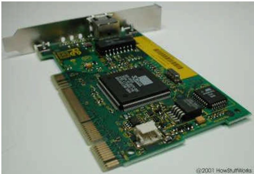
Fig. 18 Tarjeta típica PCI.
