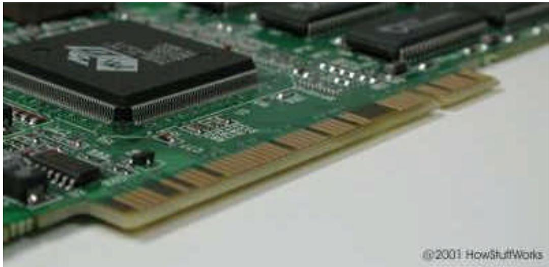
Fig.21 Pines de conexión de la tarjeta con bus PCI.
