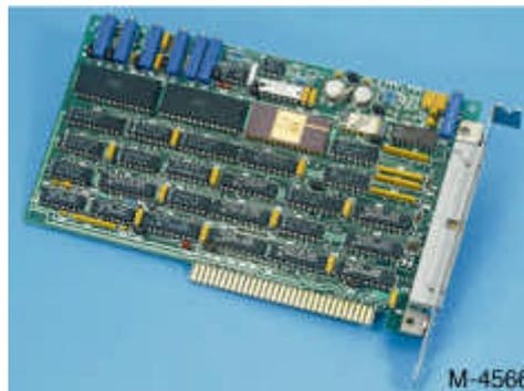
Fig.14 Modelo comercial DT2811 del fabricante Data Translation. Es una tarjeta de adquisición de datos que integra el bus ISA.
