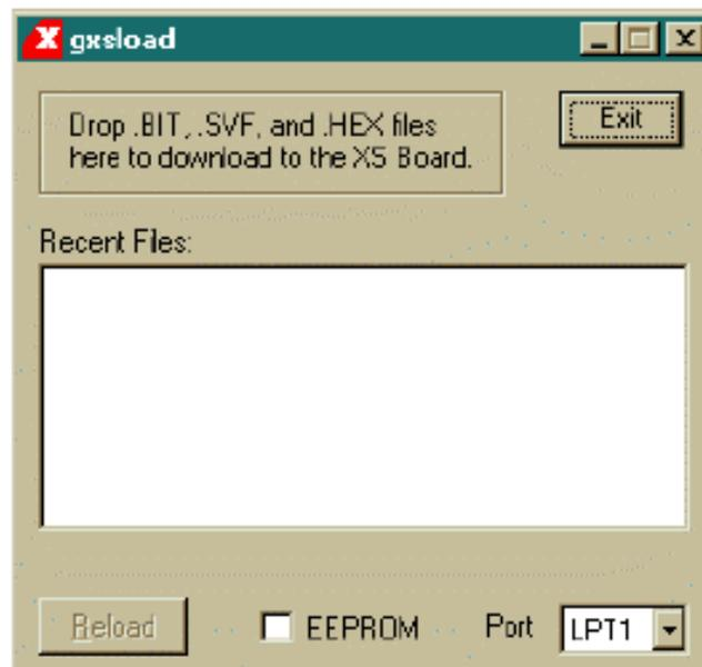
Se selecciona el puerto paralelo y se arrastra el fichero que queremos descargar hasta la ventana blanca. Así se inicia el proceso de descarga.
