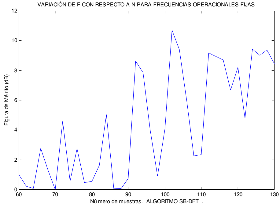
Figura 36. Variación de la figura de mérito con el número de muestras, para frecuencias operacionales fijas ( caso 1 ). Algoritmo SB-DFT.
