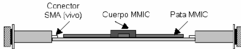
Figura 4.11. Conexión del MMIC y la placa al test fixture
