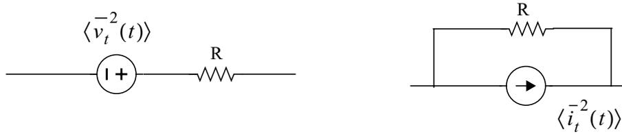
Fig. 5.1: Circuitos equivalentes de una fuente de ruido térmico para una resistencia
