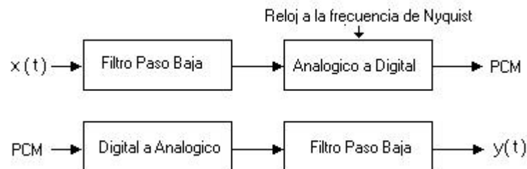
Figura 1.1. Modulación por codificación de pulsos convencional, incluyendo filtros analógicos para controlar el ruido de aliasing y suavizado de la salida.
