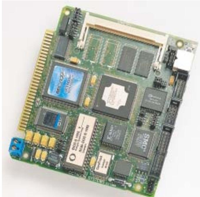
Figura 5.4: Placa SBC 5066 de Octagon Systems, utilizada en el Robosense.
