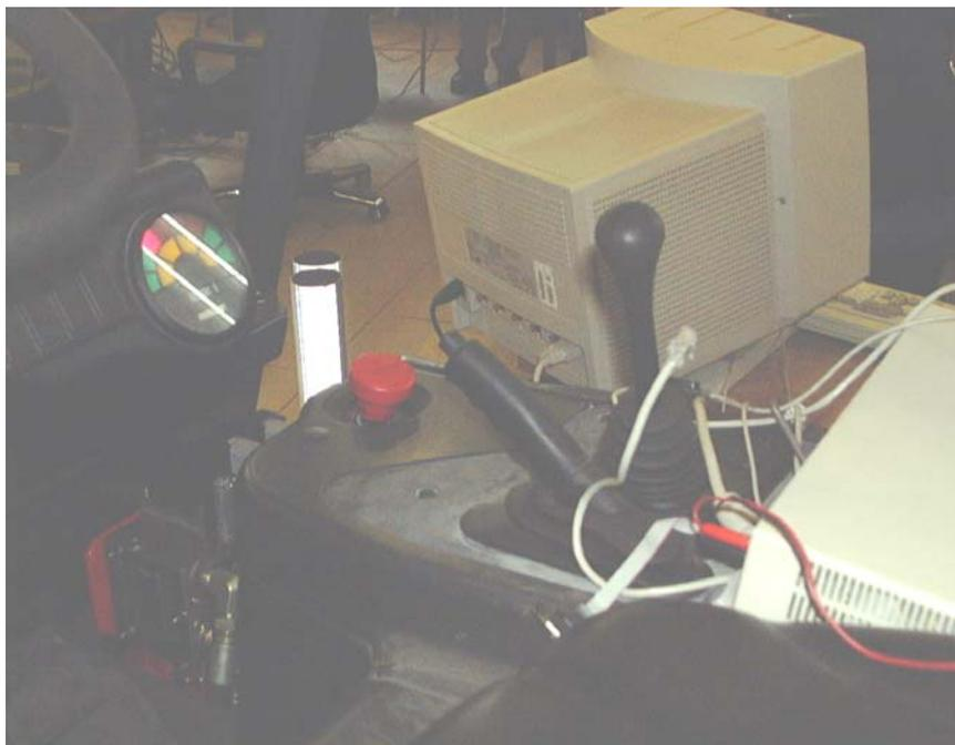
Figura 3.7: Freno de mano y palanca de control del mástil.
