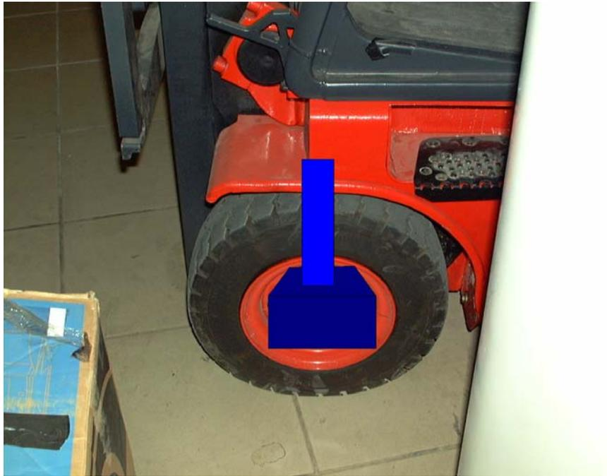
Figura 8.1: Una posibilidad de colocar un sensor de velocidad.
