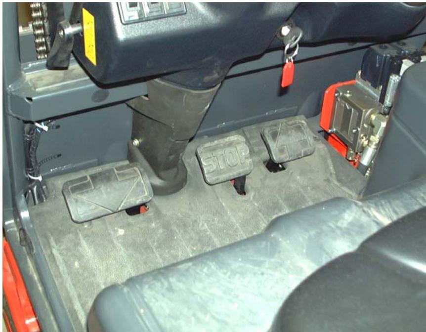
Figura 3.9: Con los pedales controlamos la tracción.
