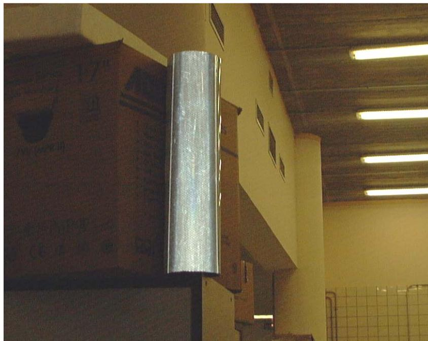
Figura 5.2: Blanco para la navegación del sensor Robosense.
