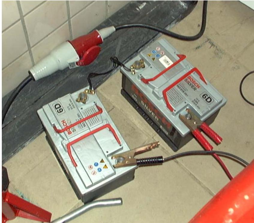
Figura 4.15: Baterías en carga a la vez, colocadas en serie.
