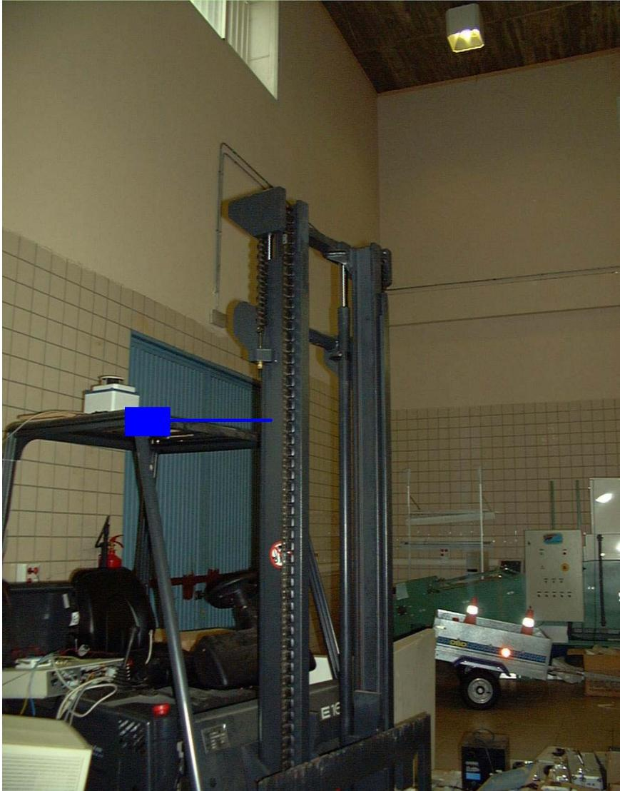
Figura 8.3: Posición del sensor para la inclinación.
