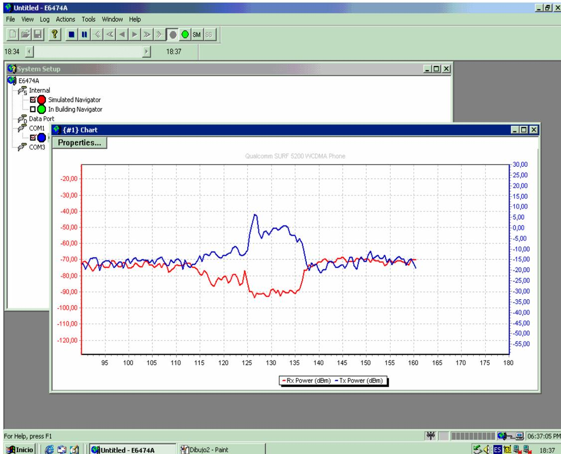
Figura 6.22. Evolución real de la potencia TX/RX frente a desvanecimiento lento.
