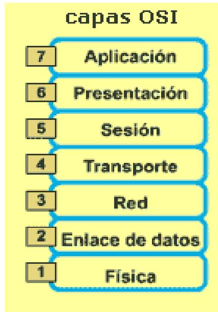
**Figura 4.1. Niveles del modelo OSI**
