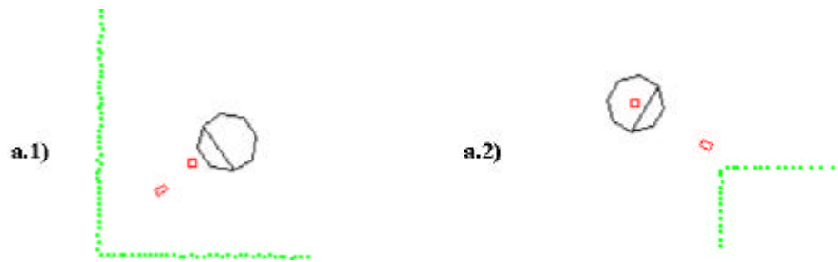
Figura 17: Posibles configuraciones de esquinas: a.1) cóncava, a.2) convexa
