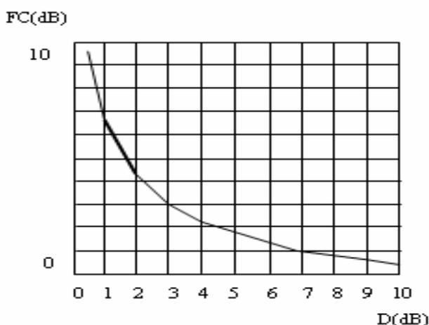
Figura 3.11: Factor de corrección en función de la diferencia entre el ruido de la red y el del analizador D(dB).
