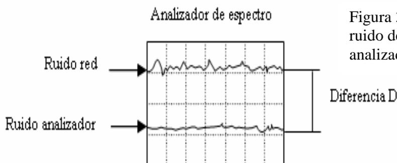
Figura 3.12: Diferencia entre el ruido de red y el interno del analizador
