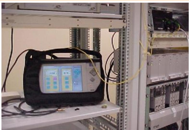
Figura 3.17: Reflectómetro óptico
