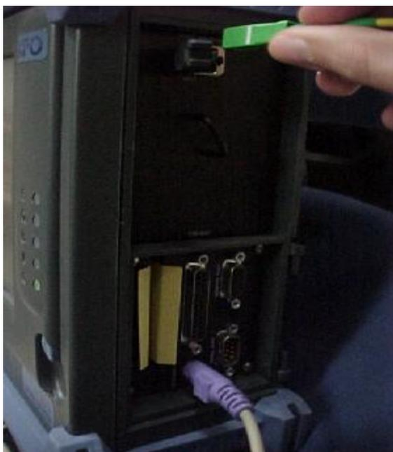
Figura 6.4: Conexión de fibra óptica al OSA
